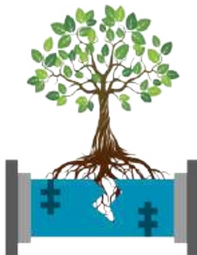
Figura 10. Ruptura de tubería por la presencia de raíces
