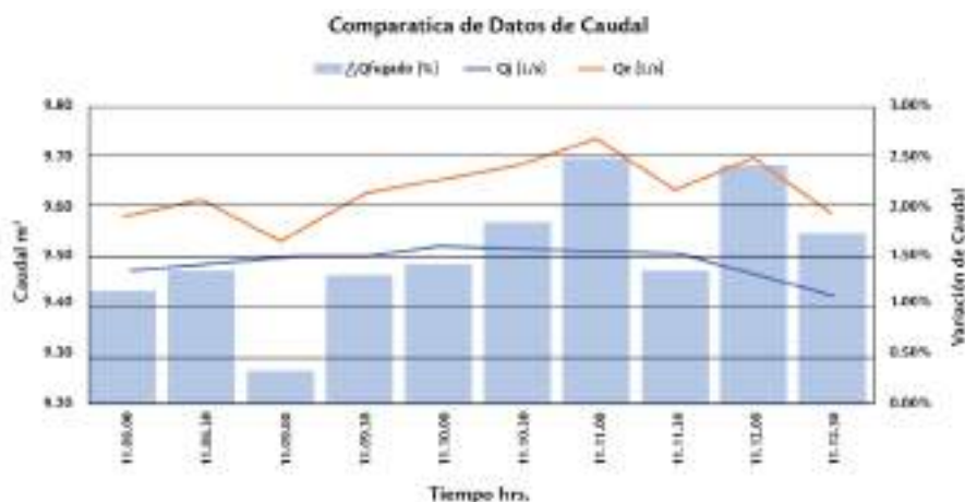
Gráfica 1. Simulación de fuga en campo, bajo condiciones controladas, obtenida con datos de campo Laboratorio de Hidráulica - UTPL, 2024.
