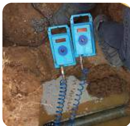
Figura 17. Data logger de presión recopilando datos Nota. Fotografía obtenida en campo; equipos propiedad de la Universidad Técnica Particular de Loja (UTPL), 2024.
