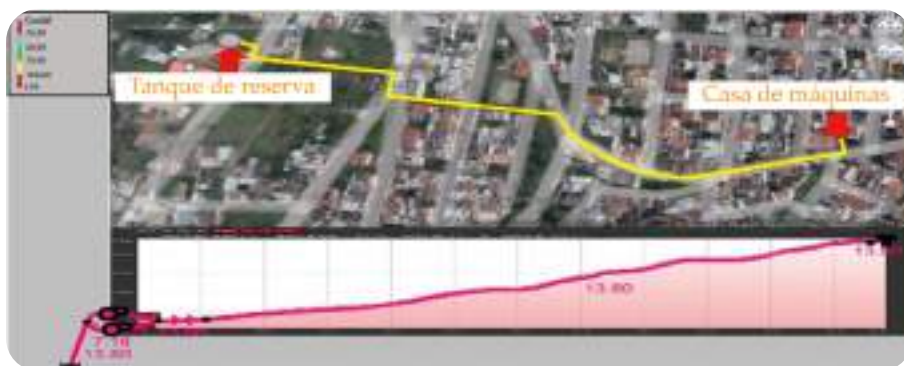
Figura 41. Perfil de impulsión, E.B. Las Peñas, bombas trabajando en paralelo
