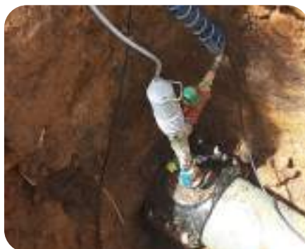
Figura 30. Data logger y micrófono de correlador instalados en accesorios conectados a la tubería
