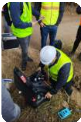
Figura 50. Correlador recibiendo la señal de ruido de fuga desde los transmisores
