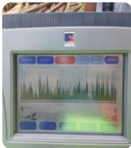
Figura 49. Correlador recibiendo la señal de ruido de fuga desde los transmisores
