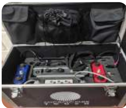
Figura 17. Correlador MicroCorr Touch
