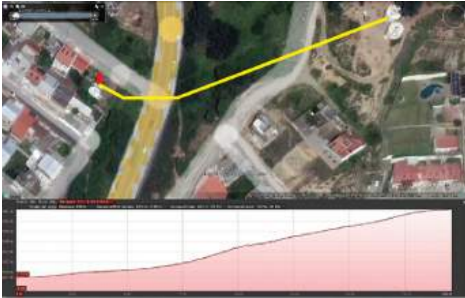
Anexo 3 Línea de impulsión de la Estación de Bombeo Clodoveo
