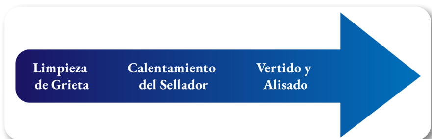
Figura 2. Esquema de aplicación del sellado de grietas
