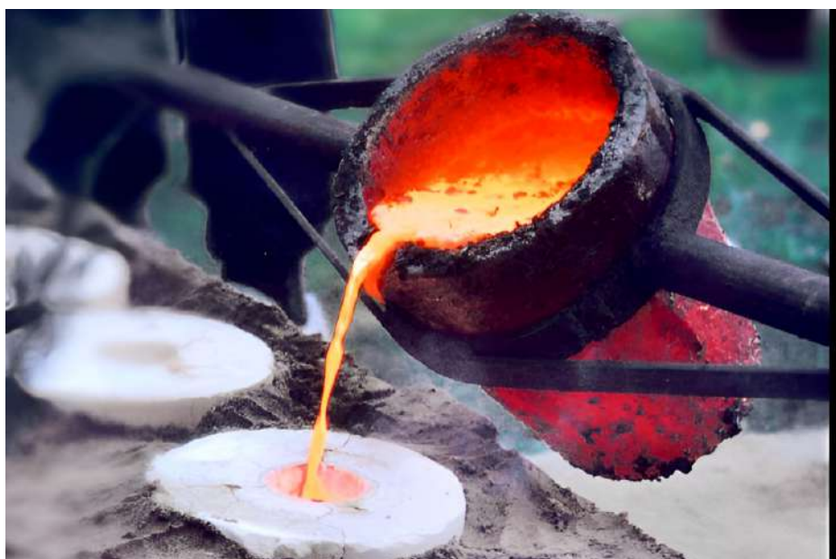
Figura 58 Bronce fundido a 1200 °C
